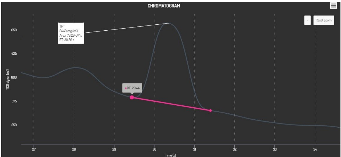
Cromatogramma 1: CP Sil 19CB analisi di THT 50,5 \text{ mg/Sm}^3 in gas naturale
